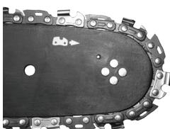
Éloignez la barre de guidage de la roue de la chaîne d'entraînement, afin que les maillons de guidage de la chaîne soient placés dans la rainure de la barre de guidage.
