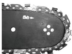
Mova a barra guia para longe da roda motriz de condução, de modo que as ligações de guia da corrente são colocadas na ranhura da barra guia.
