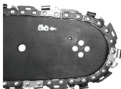
Allontanare la barra di guida dalla ruota della catena di trasmissione, in modo che i collegamenti di guida della catena siano posizionati nella scanalatura della barra di guida.
