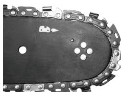
Stavite lanac na kotač lanca vodilice odozdo.
