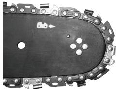
Mutati lama de ghidaj departe de roata de conducere a lantului, astfel încât zalele lantului sa fie plasate în canelura lamei de ghidaj.
